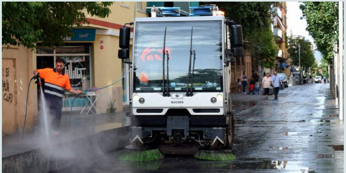
Equip de treball d'una escombradora amb pèrtiga amb aigua a pressió actuant al carrer de Sant Ramon
