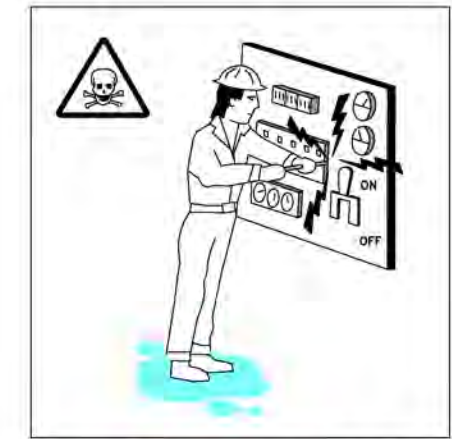
REPARACIÓ D'EQUIPS SOTA TENSIÓ
