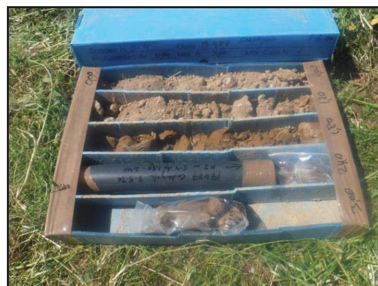
Foto 11: Sondeig S-4, caixa de 0 a 3 metres.
