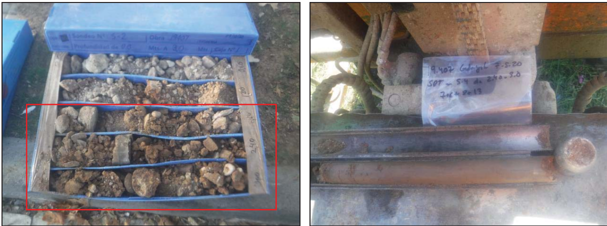
Imatges del nivell de replè R2: en una de les caixes porta-testimoni (esquerra) i en un dels assaigs SPT efectuats (dreta).
