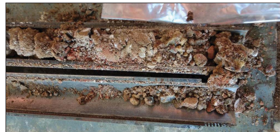
Assaig SPT a 4,4 metres de profunditat de la boca del sondeig Z1-3, on s'observen fragments de ceràmica.
