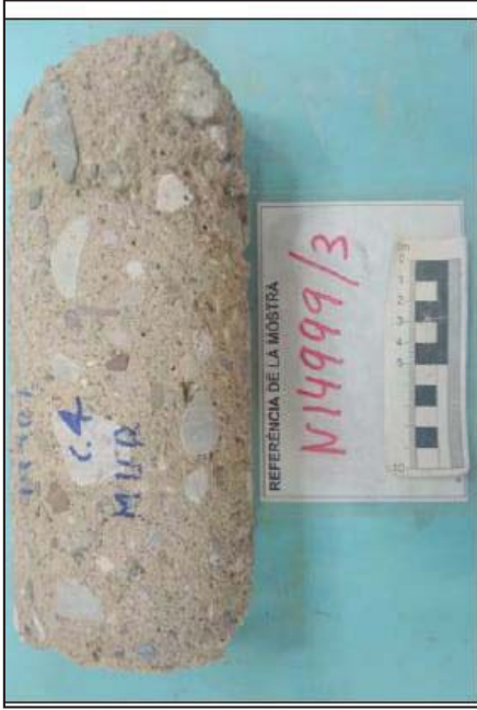
Imatge 3: Testimoni de formigó extret a la zona de la cala C-4. Es descriu com: Testimoni de formigó de 22 cm de longitud i uns 9 cm de diàmetre de color marró . El sostre és irregular rugós. No presenta secció metàl·lica. La base és rugosa irregular. L'àrid del formigó és de tipus poligènic (calcària, quars, pissarra, esquist,...) arrodonits de mida no superior a 2 cm, amb morter de sorra gruixuda a fina que presenta certa alteració i "desgranació" superficial). Porositat regular homogènia generalment inferior a 10 mm.
