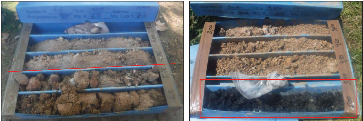
Imatges del nivell de replè R3: es marca amb una línia el nivell d'aigua i s'observa l'aspecte d'aquests materials amb diferent humitat; també es poden observar graves grans de restes de ceràmiques per sota el nivell freàtic (esquerra) i es remarca el nivell de color fosc i amb indicis organolèptics (dreta).
