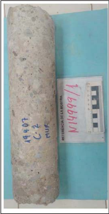
Imatge 3: Testimoni de formigó extret a la zona de la cala C-2. Es descriu com: Testimoni de formigó de 36 cm de longitud i uns 9 cm de diàmetre de color gris clar (lleugeres variacions diametral) . El sostre és polit amb pintura blavosa. No presenta secció metàl·lica. La base és rugosa irregular. L'àrid del formigó és de tipus calçari fragmentat i arrodonit de mides normalment no superiors a 2 cm. Porositat regular homògena generalment inferior a 8 mm.
