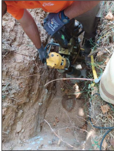
Imatge 2: Extracció del testimoni de formigó vertical del fonament del mur, dins la cala C-1.
