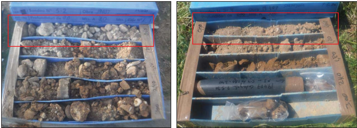
Imatges del nivell de replè R1: paviment i graves de drenatge (esquerra) i sòl vegetal (dreta).
