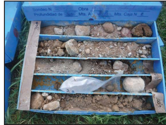
Foto 20: Sondeig S-5, caixa de 3 a 6 metres.
