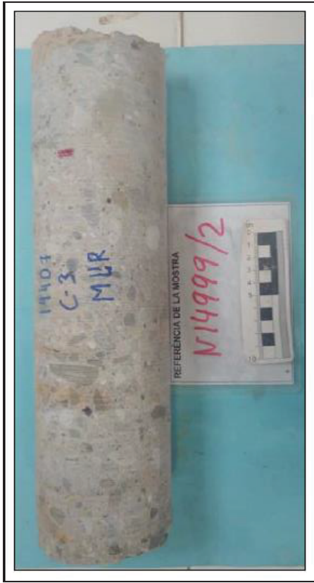
Imatge 3: Testimoni de formigó extret a la zona de la cala C-3. Es descriu com: Testimoni de formigó de 36 cm de longitud i uns 9 cm de diàmetre de color gris clar . El sostre és polit amb pintura blavosa. No presenta secció metàl·lica. La base és rugosa irregular. L'àrid del formigó és de tipus calcàri fragmentat i arrodonit de mides normalment no superiors a 2 cm). Porositat regular homogènia generalment inferior a 8 mm.
