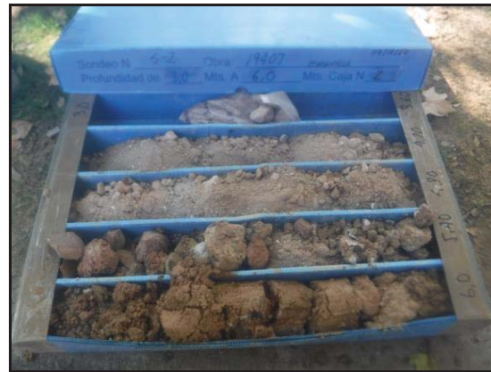
Foto 7: Sondeig S-2, caixa de 3 a 6 metres.
