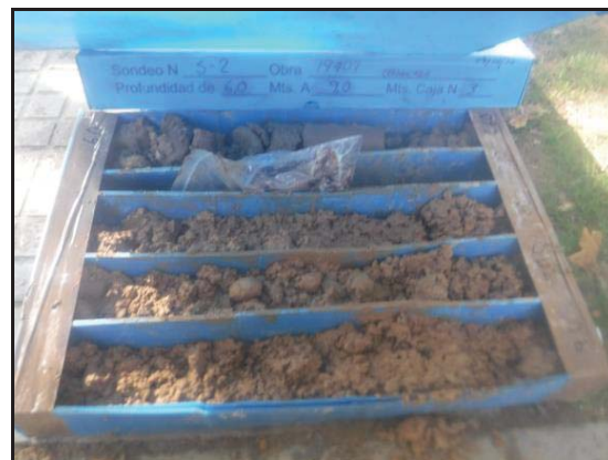
Foto 9: Sondeig S-2, caixa de 6 a 9 metres.
