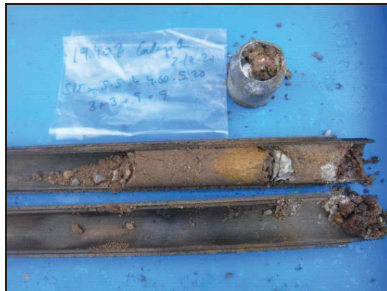
Foto 21: Sondeig S-5, SPT a 4,6 metres.
