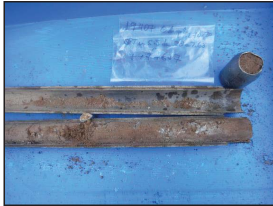
Foto 19: Sondeig S-5, SPT a 2,0 metres.
