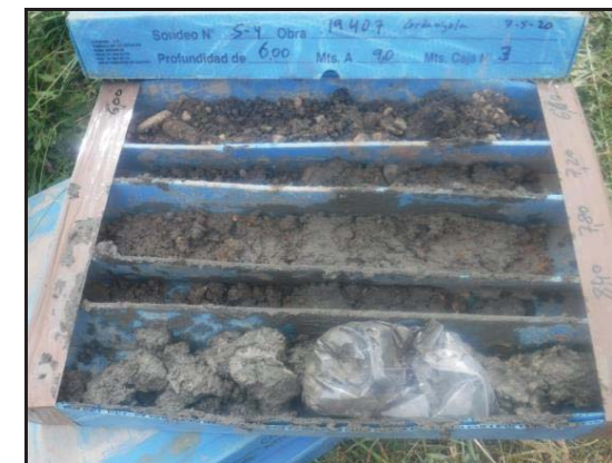
Foto 15: Sondeig S-4, caixa de 6 a 9 metres.
